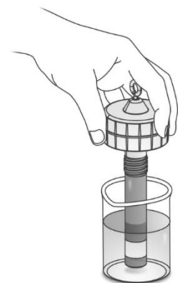
Rys. 4. Czujnik stężenia tlenu zanurzony w wodzie wraz z metalową częścią.
