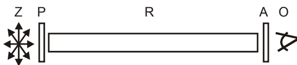
Rys.6 Schemat budowy polarymetru
